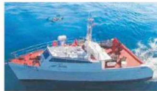
TESEO 1 La barca di circa 20 metri senza equipaggio, sviluppata da Seastema (gruppo Fincantieri), che fa parte del progetto «Marin»
